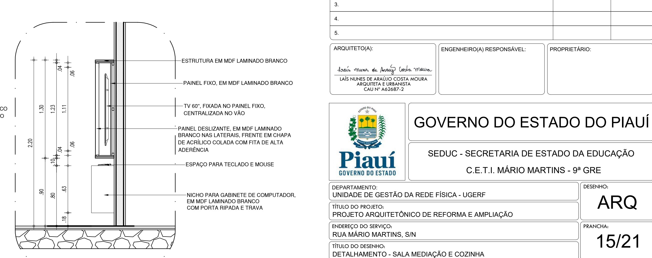
DETALHE F (quadro sala de mediação) - CORTE 01 ESCALA : 1/25
